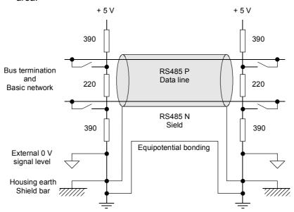
Fig. 8.1-12 Shielding and equipotential bonding
