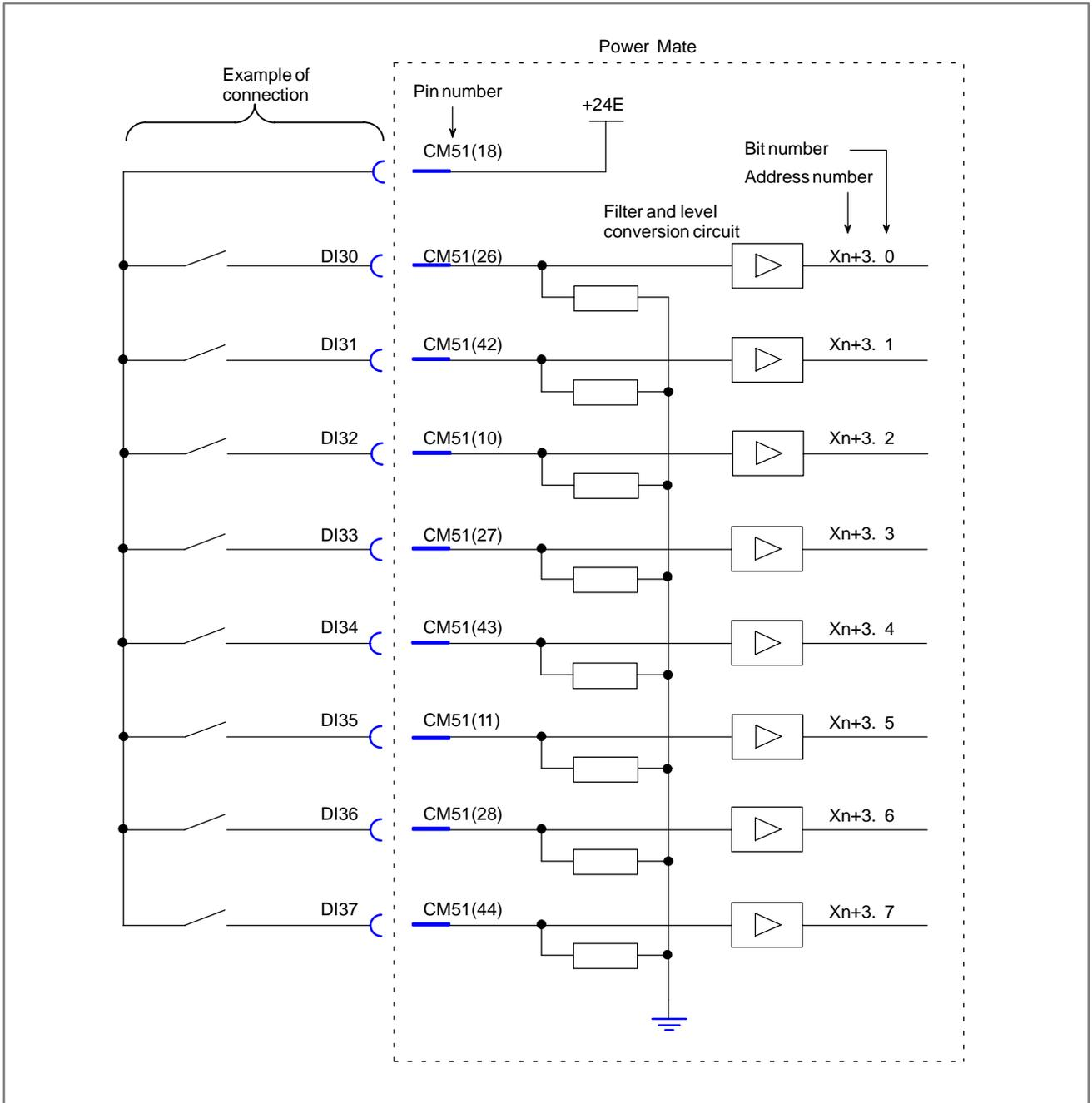
Fig. 6.6.3 (d) I/O card machine interface (4)
