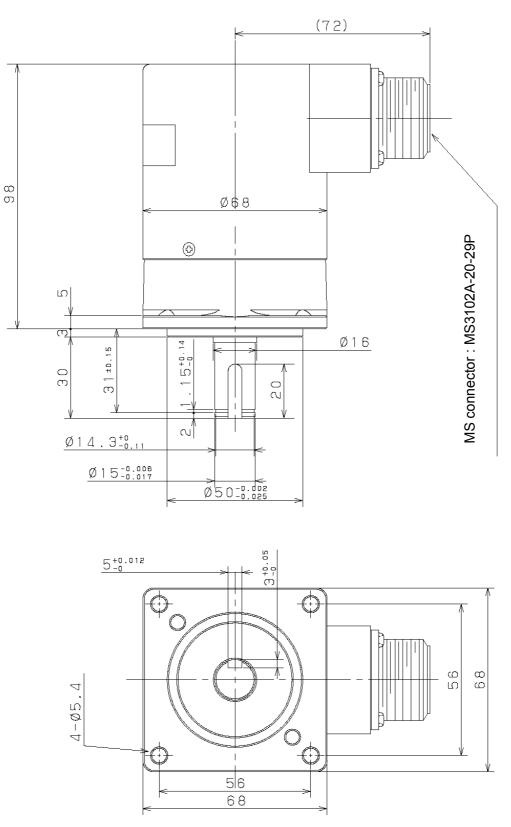
Fig.6.5.4 Pulsecoder aA1000S
