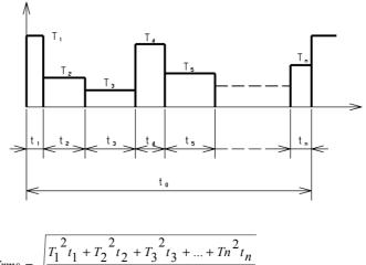
$$Trms = \sqrt{\frac{T_1 \ t_1 + T_2 \ t_2 + T_3 \ t_3 + \dots + Tn^2 t_1}{t_0}}$$
