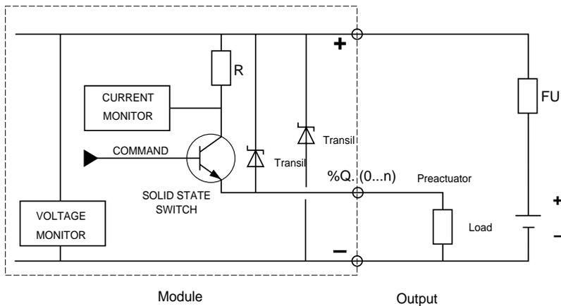
**TSX DSY 08T2/08T22 module connections**
