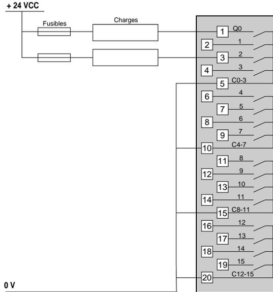
**Relay output module : TSX DSY 08R4D**
