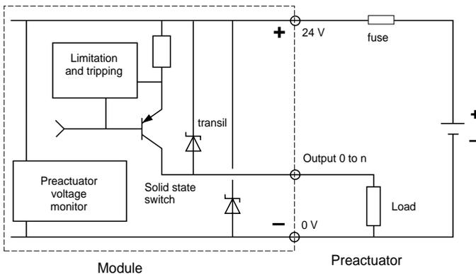
TSX DSY 32T2K module connections
