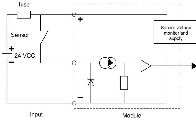
TSX DEY 32D2K module connections
