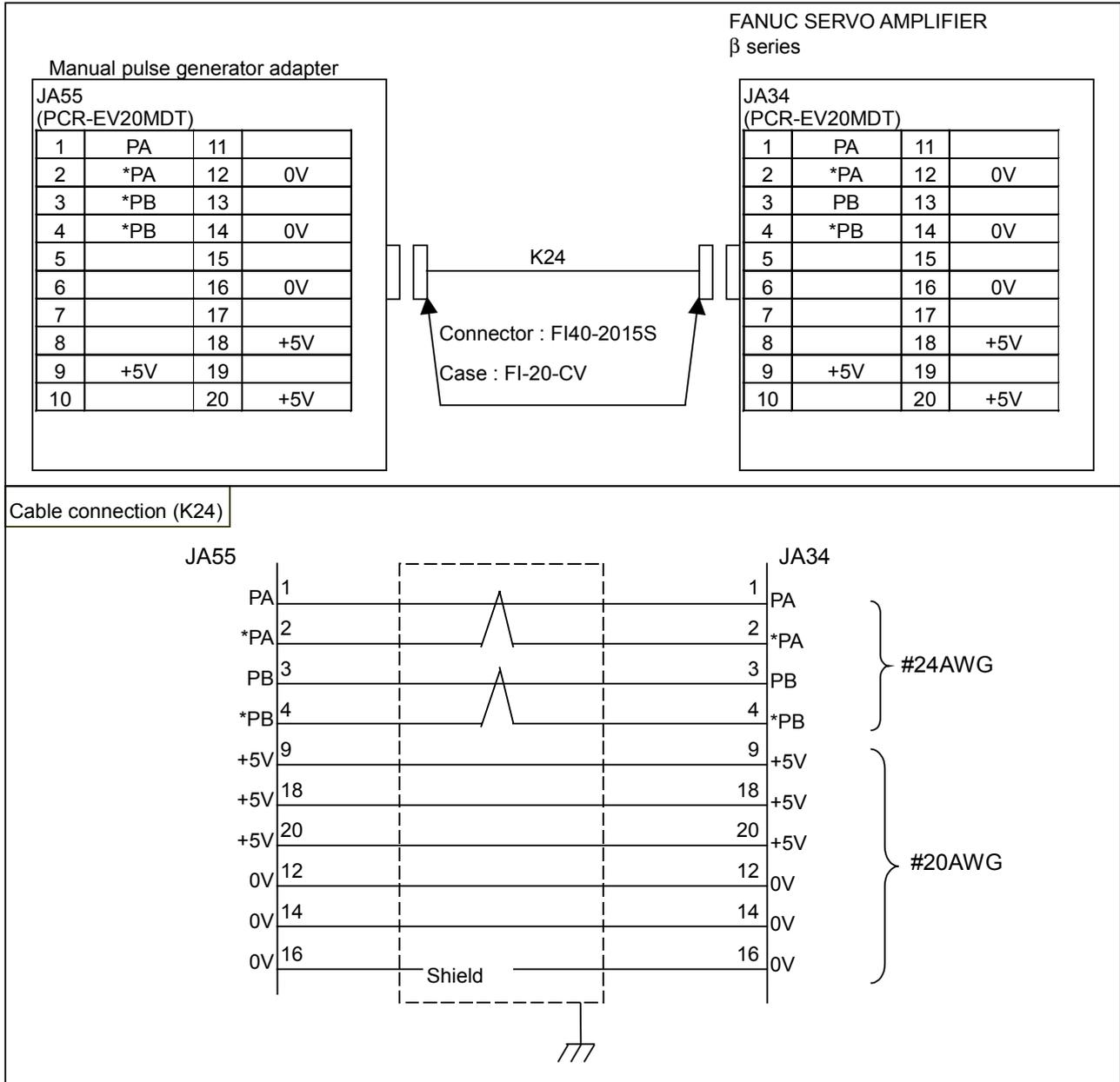
Recommended wire : A66L-0001-0286(#20AWG  $\times$  6 + #24AWG  $\times$  3 pairs)
