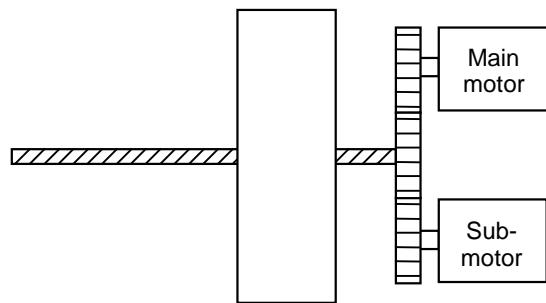
Fig. 4.17.10 (d) Example of tandem control
