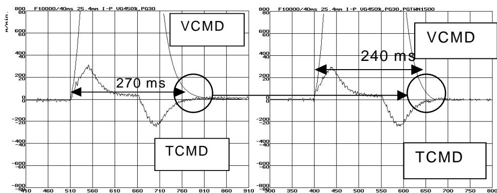
Fig. 3.4.4 (d) Position gain switch function
