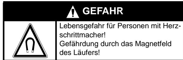
Kennzeichnen Sie den Ort der Lagerung deutlich mit den Warnhinweisen entsprechend der Verpackung der Einbaumotoren!
